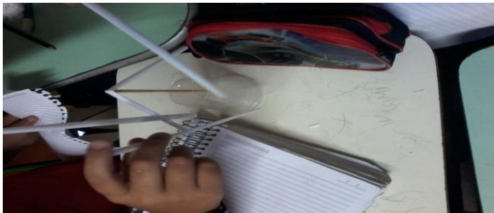
Figura 2: Experimento do canudo giratório ao ser atritado na folha.
